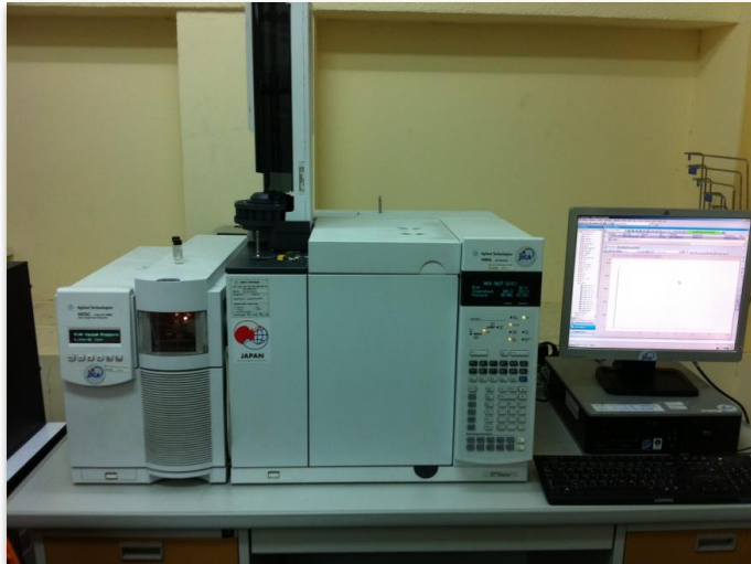
รูปที่ 2-5 เครื่อง GC-MS และ GC-FID (Agilent Technologies 5975C, JICA)
